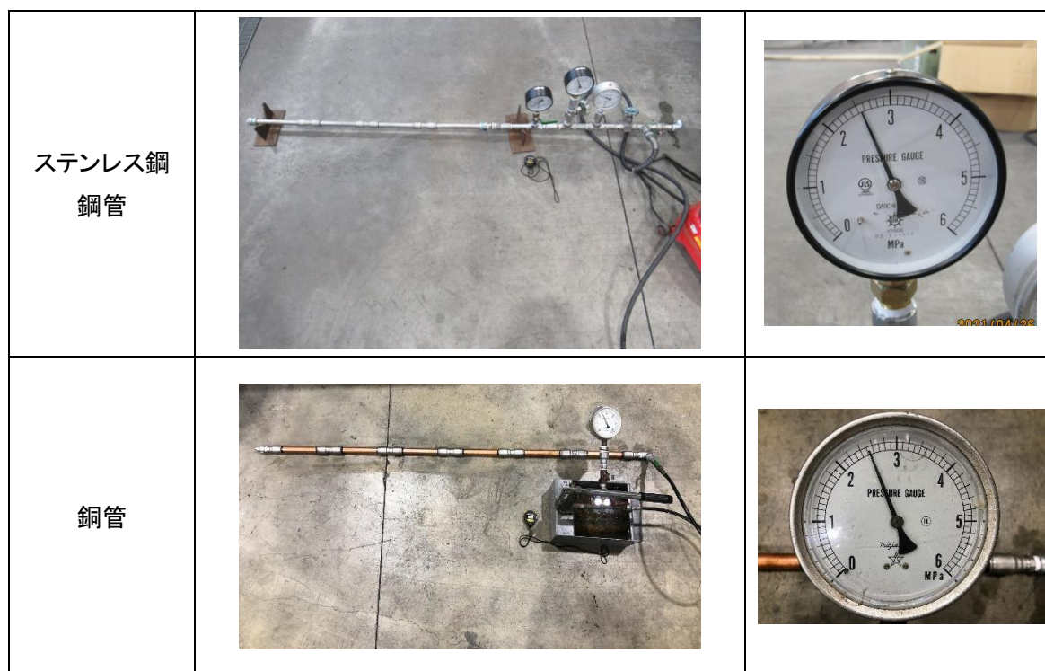
写真 4-3 水圧試験写真
