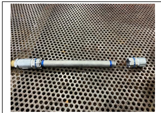
写真 4-19-1 内圧繰り返し試験後の破壊水圧試験状態
