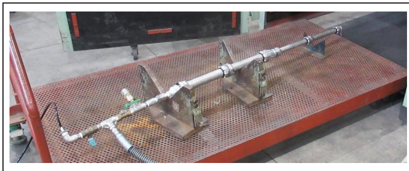
写真 4-6 内圧繰り返し試験状態
