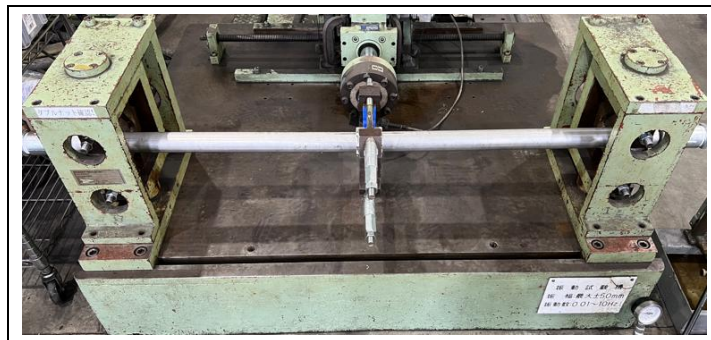
写真 4-22-1 耐震試験(加速度 2,000Gal)状態
