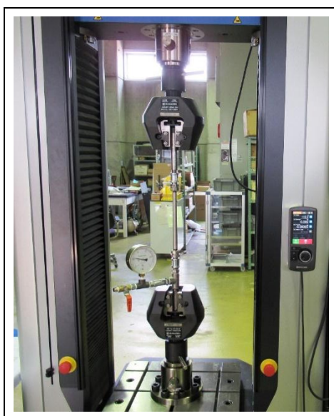
写真 4-4 引抜試験状態
