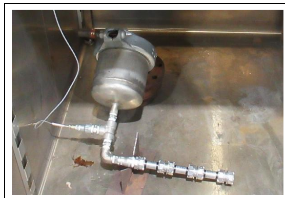
写真 4-9 実体による促進劣化試験状態
