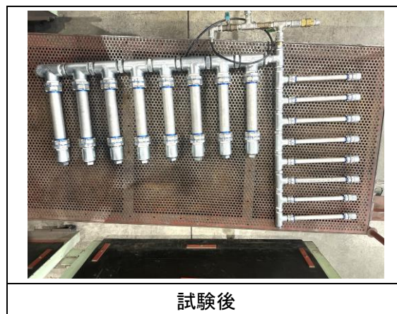
写真 4-19 内圧繰り返し試験状態
