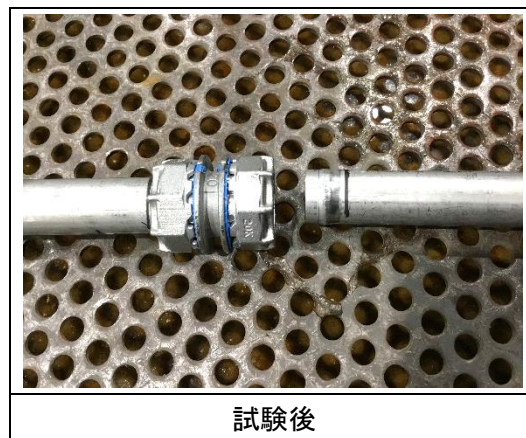
写真 4-13 破壊水圧試験状態
