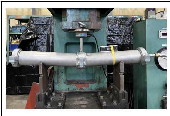
写真 4-9-3 曲げ破壊試験 (ステンレス鋼管角リング)
