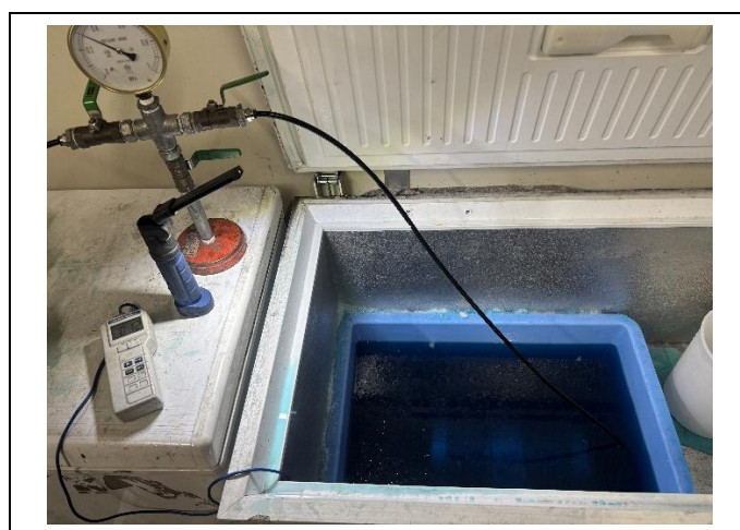
写真 4-18 低温気密試験
