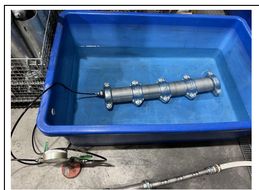
写真 4-6-2 気密試験 (ステンレス鋼鋼管転造形)
