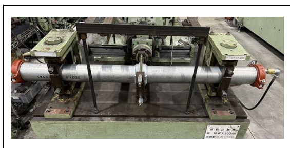
写真 4-14-1 繰返し曲げ試験 (軽量鋼管転造形)
