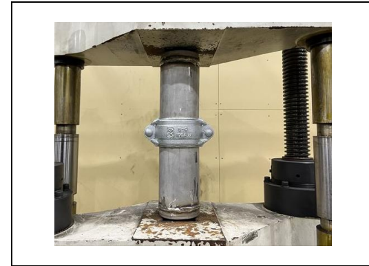
写真 4-10-4 引張強度試験 (ステンレス鋼鋼管丸リング)
