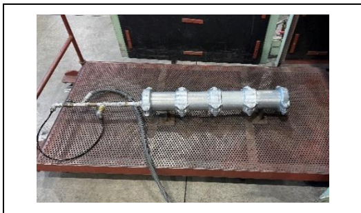
写真 4-4-1 内圧繰返し試験 (軽量鋼管転造形)
