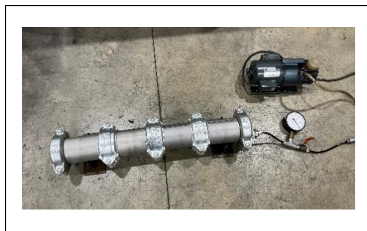
写真 4-3-2 負圧試験 (ステンレス鋼管転造形)
