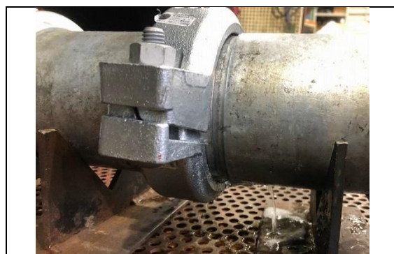
写真 4-16-2 R-0 II 手締め時の耐圧試験
