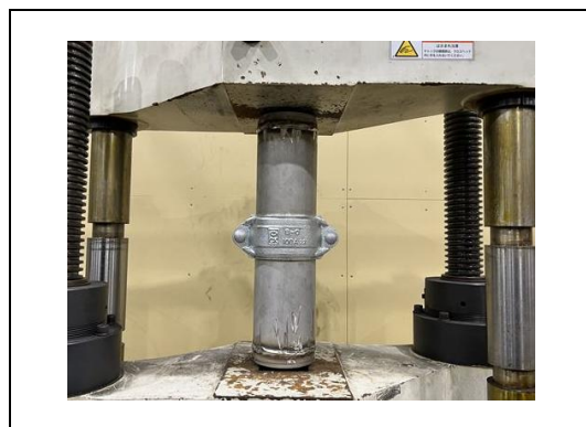
写真 4-10-3 引張強度試験 (ステンレス鋼鋼管角リング)
