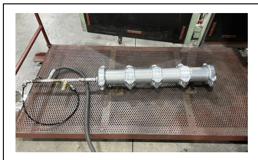
写真 4-7-1 水撃圧試験 (軽量鋼管転造形)
