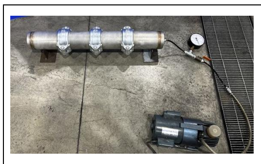
写真 4-3-3 負圧試験 (ステンレス鋼管角リング)
