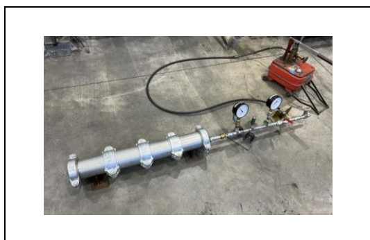
写真 4-2-1 耐圧試験 (軽量鋼管転造形)
