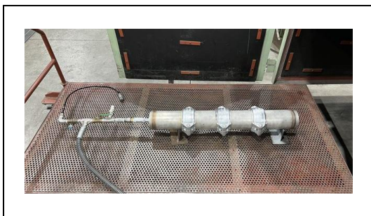
写真 4-4-3 内圧繰返し試験 (ステンレス鋼管角リング)
