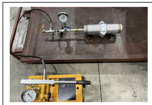
写真 4-8-2 破壊試験 (ステンレス鋼管転造形)
