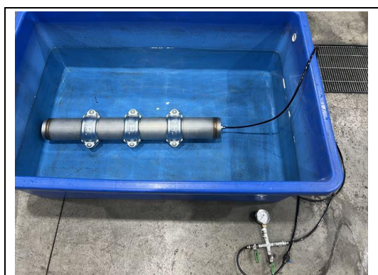
写真 4-6-3 気密試験 (ステンレス鋼鋼管角リング)
