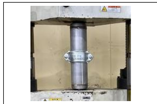
写真 4-10-2 引張強度試験 (ステンレス鋼鋼管転造形)
