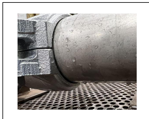
写真 4-11-2 破壊水圧試験 (ステンレス鋼鋼管転造形)
