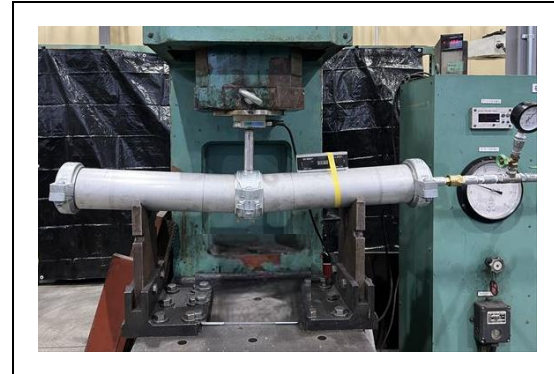
写真 4-9-4 曲げ破壊試験 (ステンレス鋼管丸リング)
