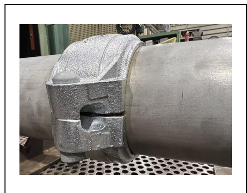
写真 4-11-3 破壊水圧試験 (ステンレス鋼鋼管角リング)
