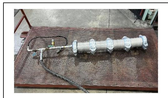
写真 4-4-2 内圧繰返し試験 (ステンレス鋼管転造形)
