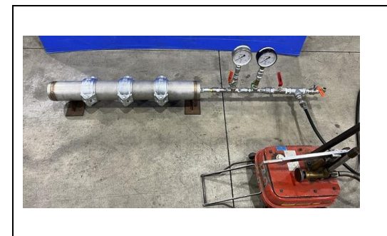
写真 4-1-4 漏れ試験 (ステンレス鋼管丸リング)
