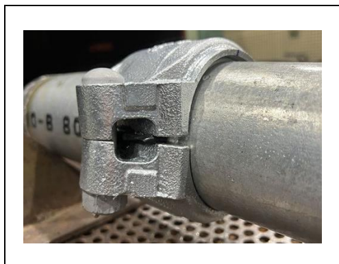
写真 4-11-1 破壊水圧試験 (軽量鋼管転造形)
