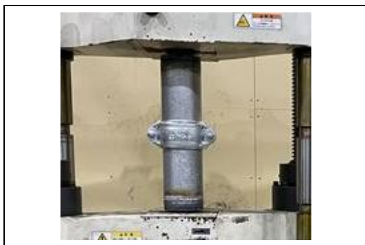
写真 4-10-1 引張強度試験 (軽量鋼管転造形)
