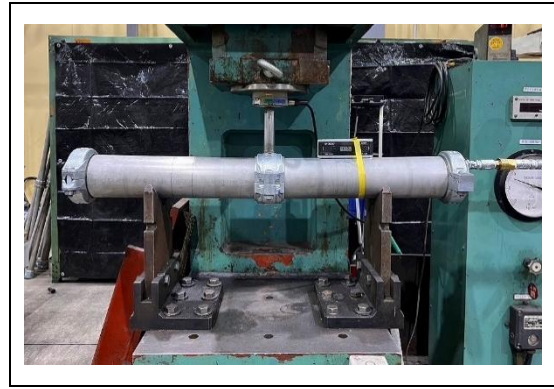
写真 4-9-2 曲げ破壊試験 (ステンレス鋼管転造形)
