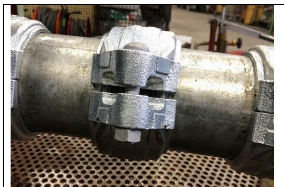
写真 4-16-1 B-0 手締め時の耐圧試験
