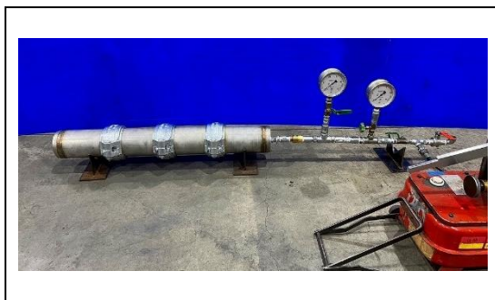
写真 4-1-3 漏れ試験 (ステンレス鋼管角リング)
