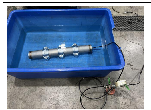
写真 4-6-4 気密試験 (ステンレス鋼鋼管丸リング)
