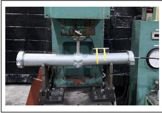
写真 4-9-1 曲げ破壊試験 (軽量鋼管転造形)
