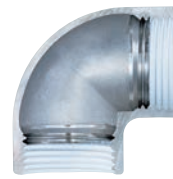
ZD SUS継手の断面(写真) ねじ奥にシール剤を塗布しないことで 端材の混入を防止、 接続部の緩み防止に効果あり
