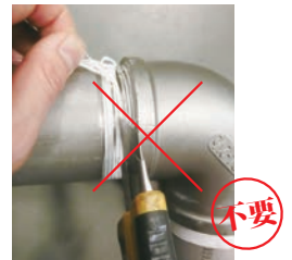
ZD SUS継手の断面(写真) ねじ奥にシール剤を塗布しないことで 端材の混入を防止、 接続部の緩み防止に効果あり
